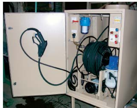
Рис. 7.8. Устройство очистки, промывки и дезинфекции внутренней поверхности ствола мусоропровода
